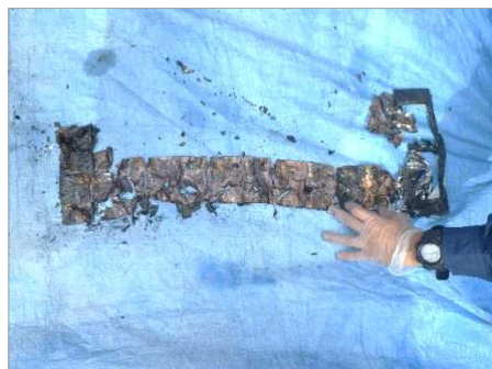
荷箱から発見された焼けただれたリチウムイオン電池
