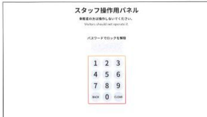
タッチパネル操作が5分間無い場合、ロック画面になり、操作ができない状態になる。4桁の数字パスワードを入力してロックを解除し、操作画面にもどる。
