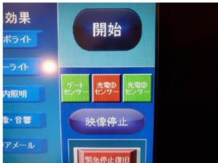
※「緊急停止スイッチ」を押さずに、「緊急停止復旧」ボタンのみを押すと機械原点に戻らず、その状態で再度起震装置を動かすと、起震台が外枠に乗り上げる等の危険性がある。
