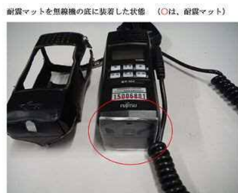
図4 提案番号第 647 号 「耐震マットを使用した無線機保護について」
