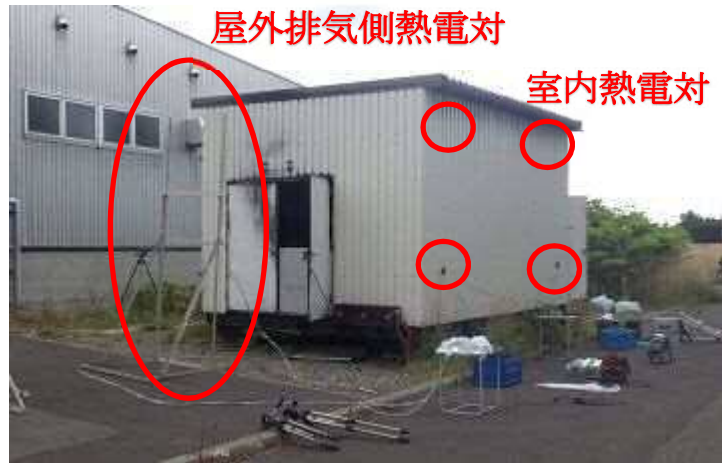
図8 熱電対設置位置(室内及び屋外排気側)
