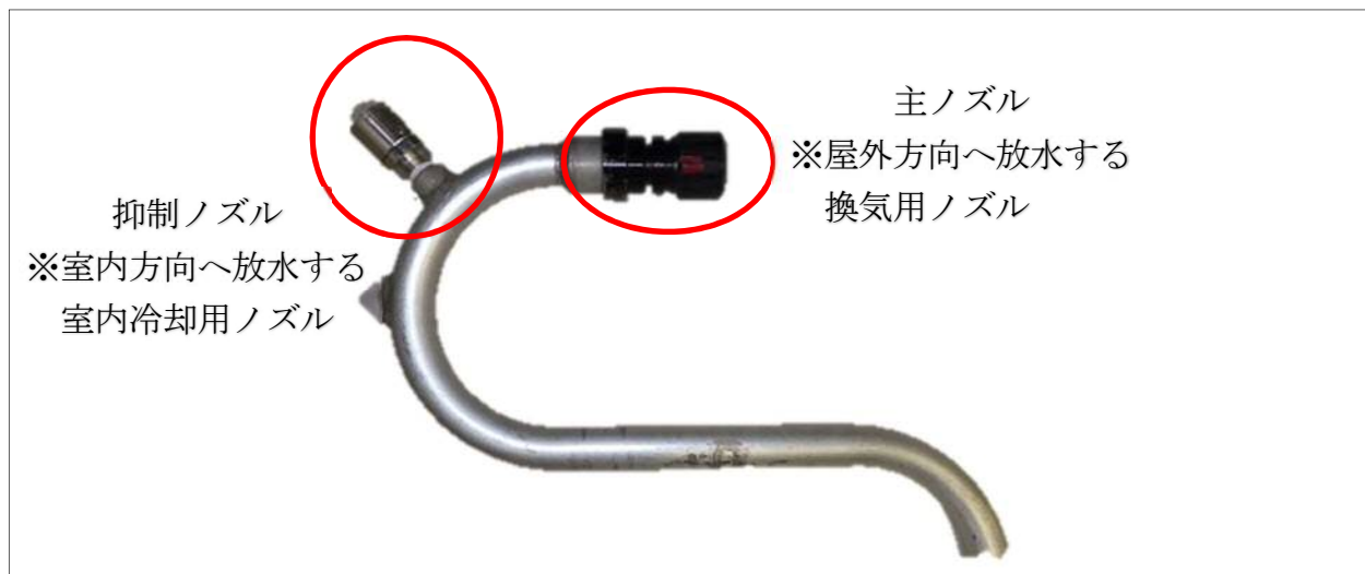
図2 水力換気ノズル各部分の名称
