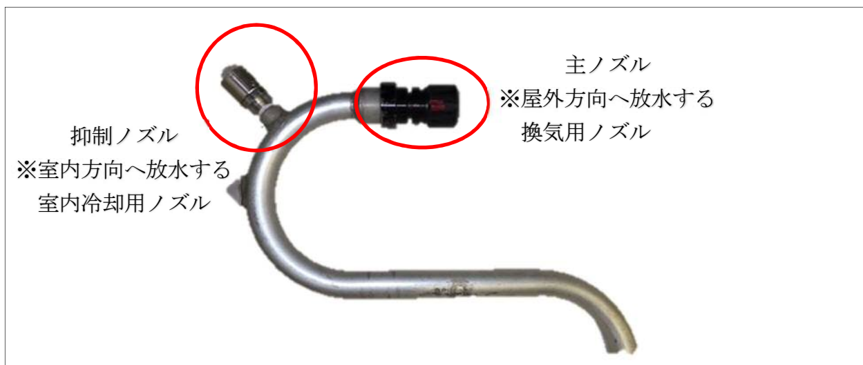
図2 水力換気ノズル各部分の名称
