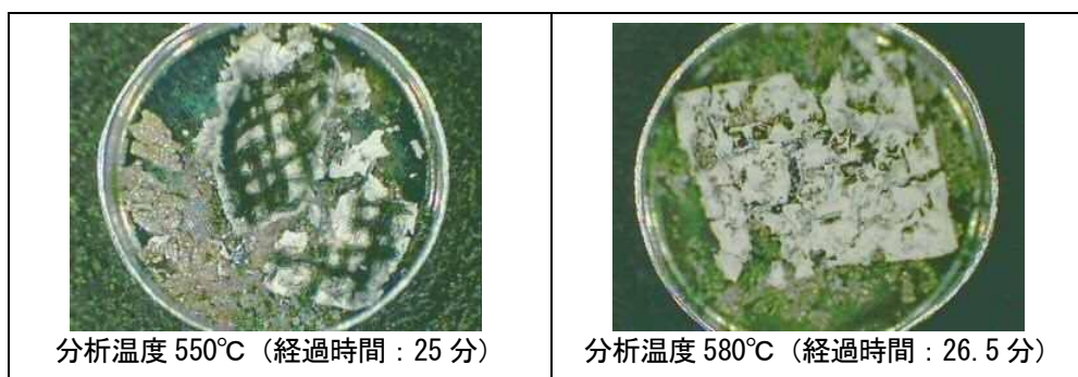
図 15 試料 3 の受熱変化の状況 (空气中・昇温速度 20°C/min)
