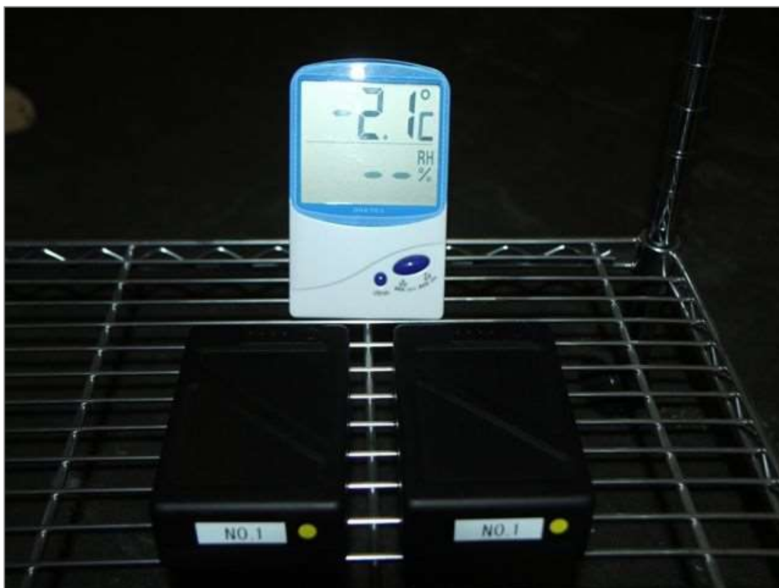
写真2 バッテリー静置時の状況（低温実験ユニット設定温度:0°C）
