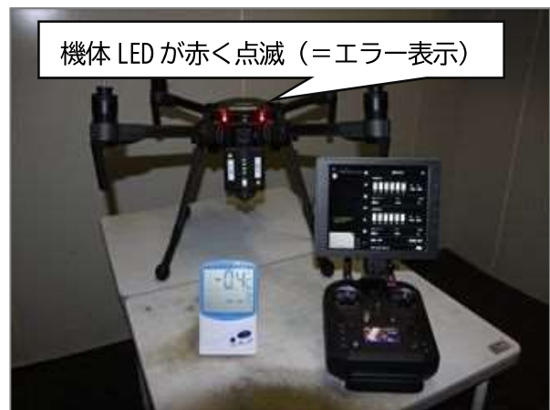
写真 5 バッテリー接続時の状況 （低温実験ユニット設定温度: 約 0℃）
