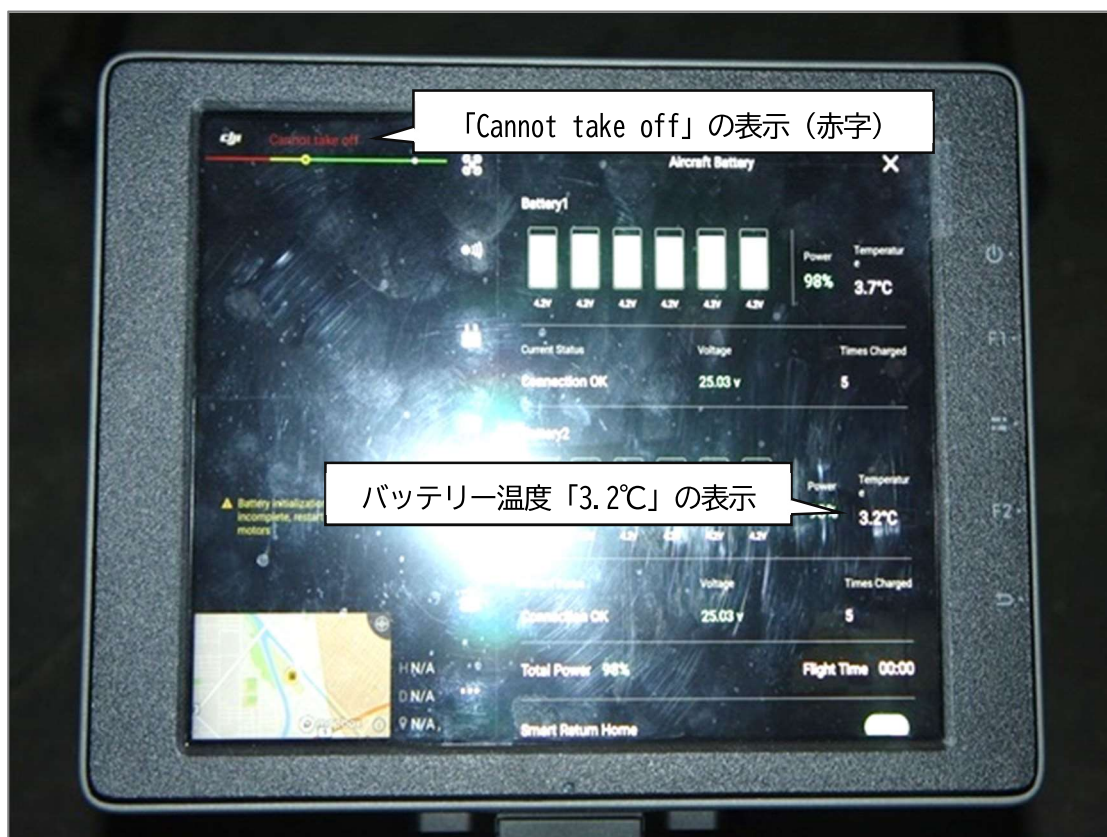
写真3 電源投入直後のプロポのディスプレイの状況（低温実験ユニット設定温度:10°C）
