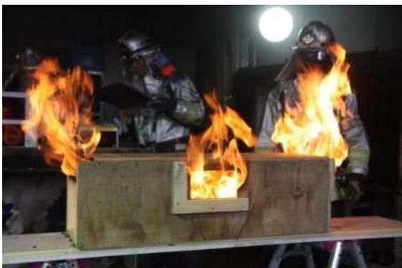
写真3 木製模型を使用した燃焼実験状況①
