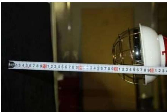
写真 1 白熱灯投光器の離隔距離 (30cm)
