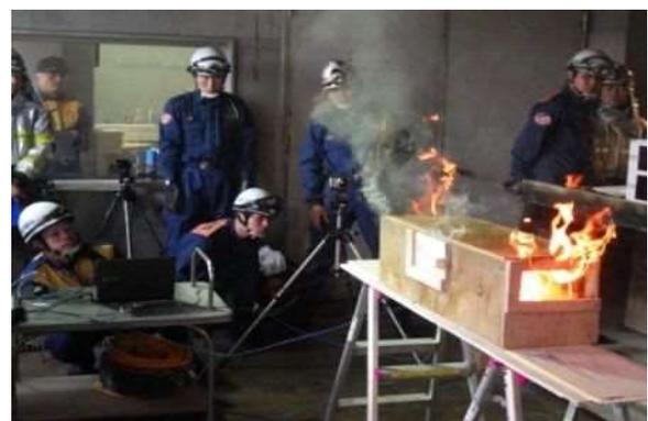
写真4 木製模型を使用した燃焼実験状況②
