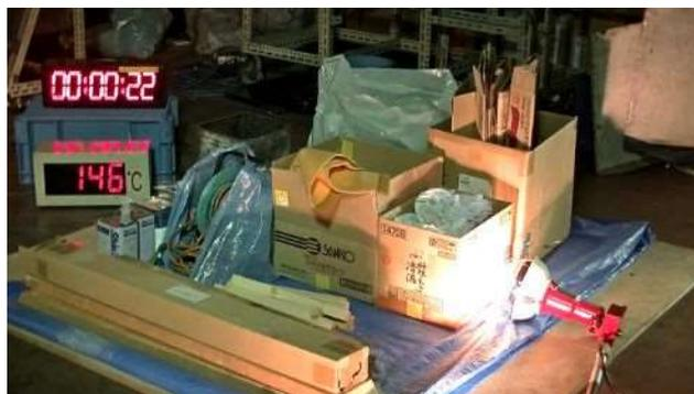
写真3 白熱灯投光器からの出火再現実験状況
