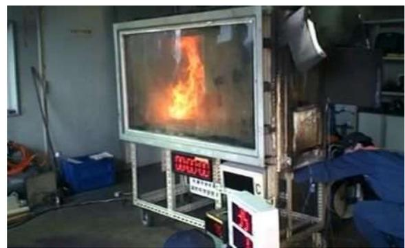
写真2 路上注水の有効性の検証実験
