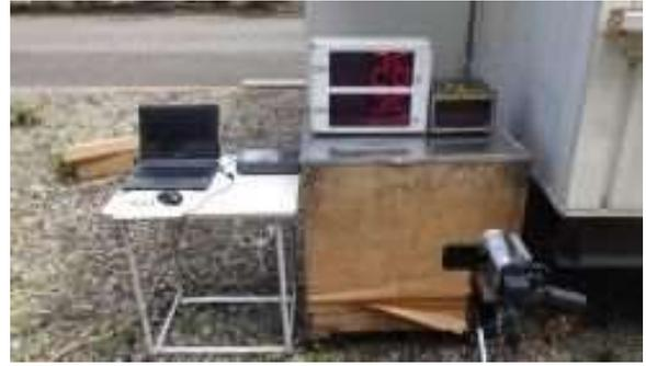
写真6 データロガー及び温度測定器の設定状況
