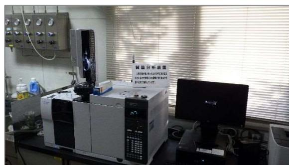
写真 ガスクロマトグラフ質量分析装置 (GC-MS)
