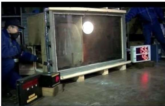
写真1 ブロアー使用を想定した排煙効果の検証実験
