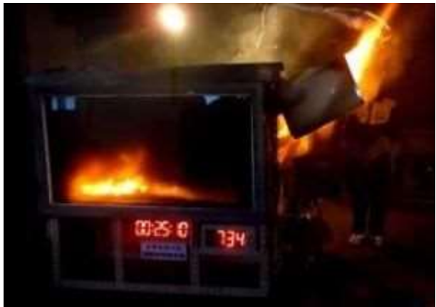
写真19 フラッシュオーバー発生後2
