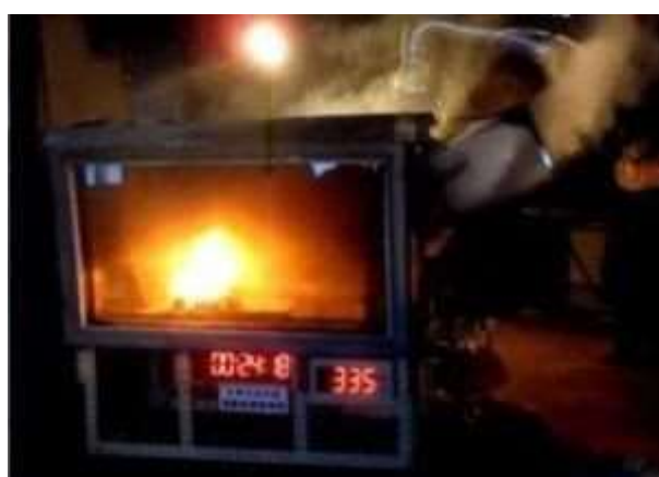
写真16 フラッシュオーバー発生直前
