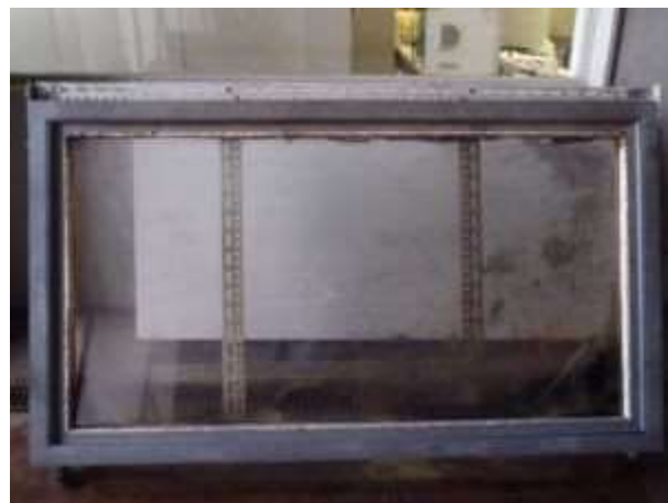
写真6 耐熱ガラス及び窓枠（前面）
