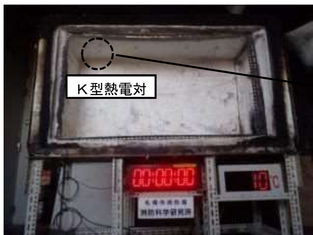
写真 1 1 K型熱電対設置状況 1
