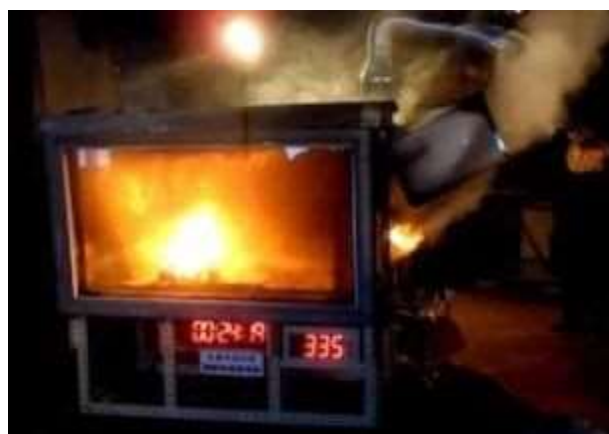
写真17 フラッシュオーバー発生時 (着火後24分19秒経過)
