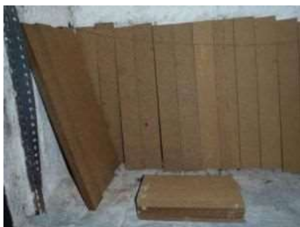
写真9 燃烧材及び着火材設定状況 1
