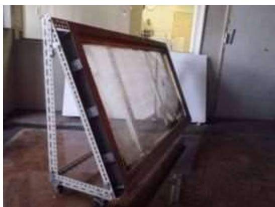
写真7 耐熱ガラス及び窓枠（側面）
