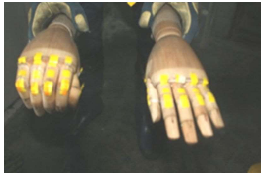
写真 9 ハンドモデルとサーモテープを用いた熱気による危険部位の確認
