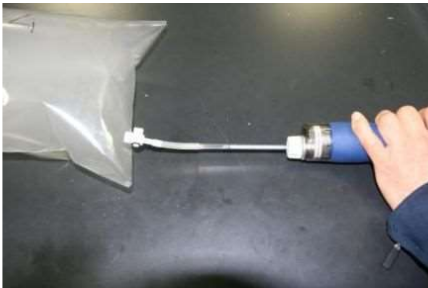
写真1 サンプルバック内のガス濃度測定状況
