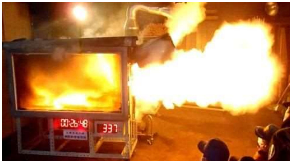
写真23 バックドラフト発生時（着火後26分48秒経過）
