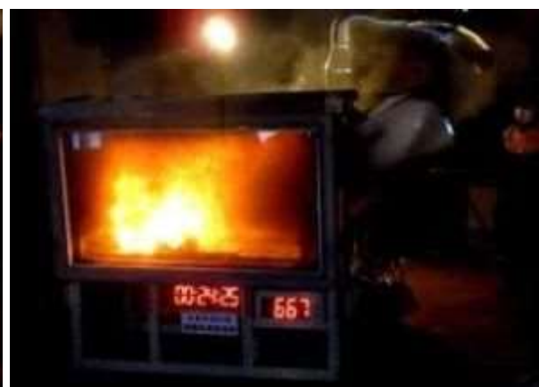
写真18 フラッシュオーバー発生後1
