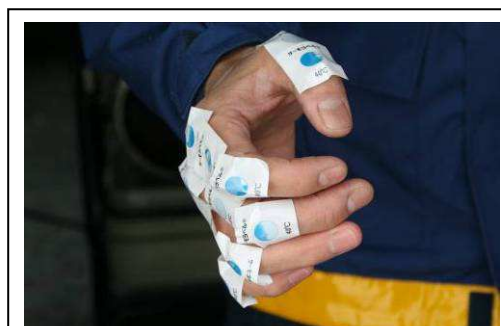
写真7 サーマラベルの反応状況
