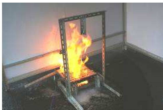
写真 No. 11 小型クリブ (着火時の状況)
