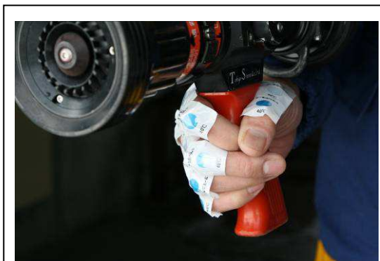
写真5 サーマラベルの反応状況（青色）
