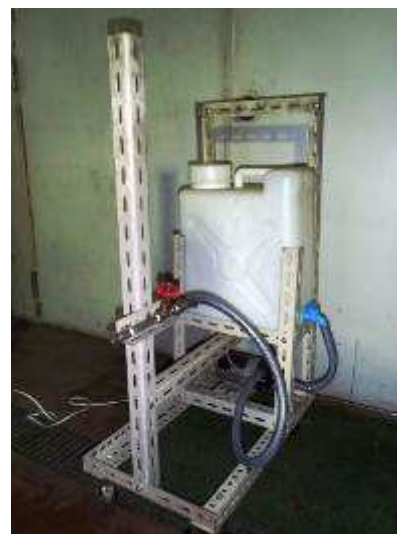
写真 No. 4 放水装置外観
