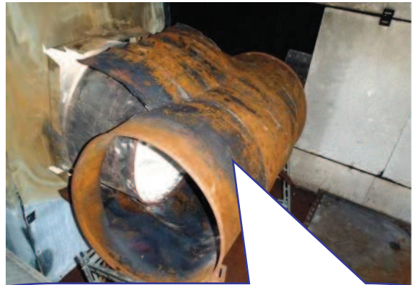
燃焼筒（外筒）：ドラム缶2本をT字状に加工し放水可能とした（水が燃焼筒内に入らない構造）。
