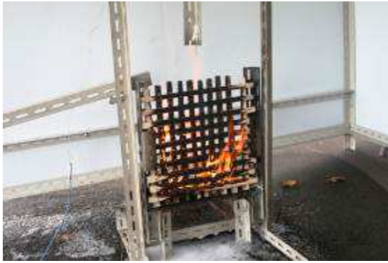
写真 No. 12 小型クリブ（垂直燃焼時の状況）
