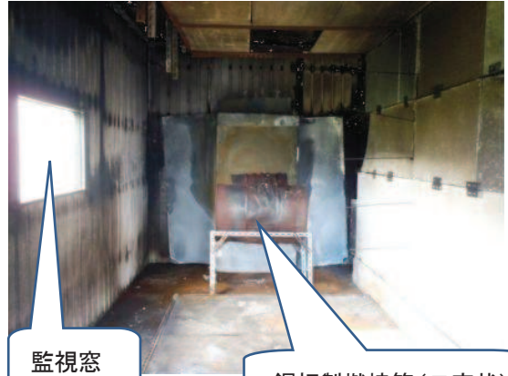
鋼板製燃焼筒（T字状）
