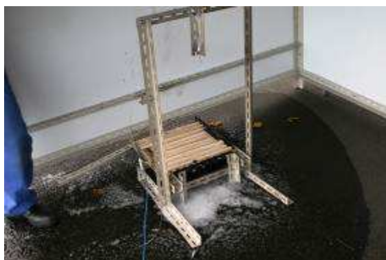
写真 No. 10 小型クリブ (燃焼前の状況)
