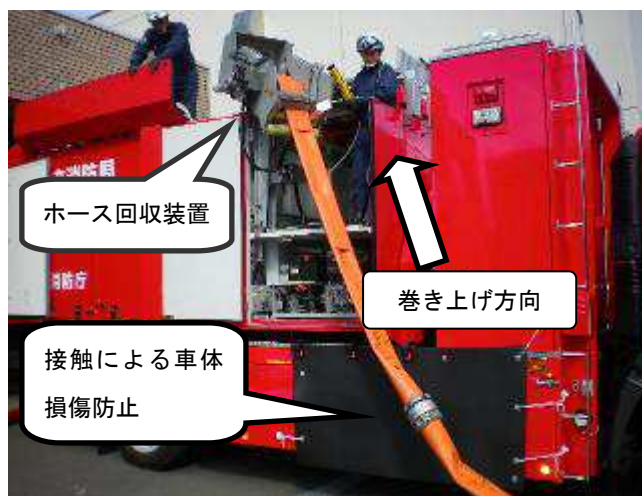
ホース巻上げ作業状況
