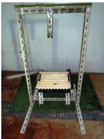
写真 No. 6 燃焼台（小型クリブ水平状態）
