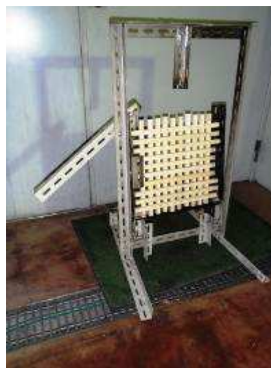
写真 No. 7 燃焼台（小型クリブ垂直状態）
