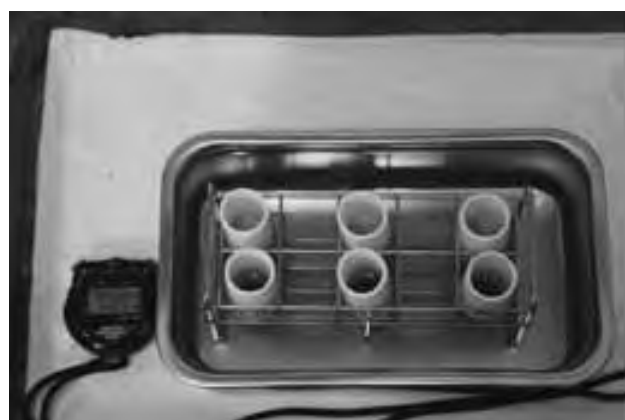
写真 23 上パーライト、下も～すべらない軽油2ℓ浸し
