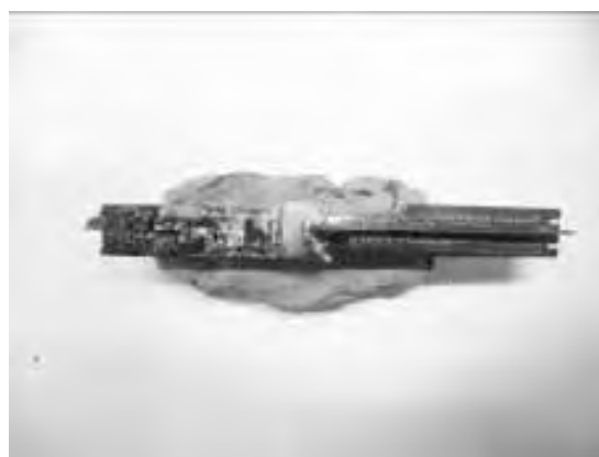
【写真16】 実験後の基板及び電熱線
