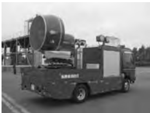
写真2 大型ブローカー車
