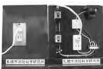
写真 10 トラッキング実験
