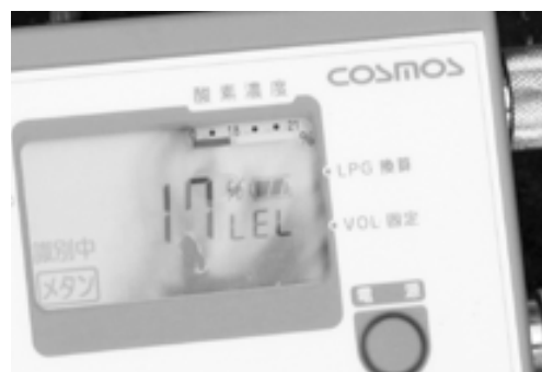
写真5 メタンガスの検知状況
