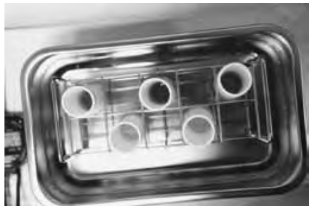
写真 16 円筒濾紙のみブランク灯油 2 ℓ 浸し
