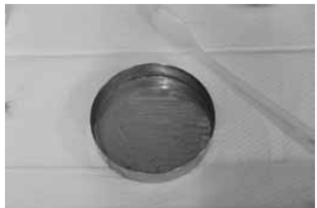
写真 35 灯油を浸み込ませたゼオライト S を濾紙に全て入れた後のシャーレの状況
