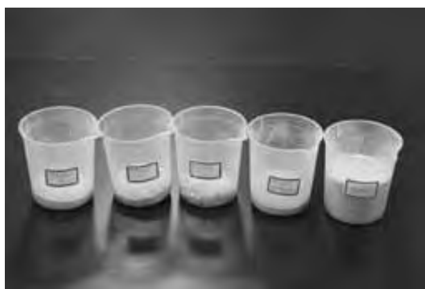
写真11 油吸着剤5種類各5gの体積比較 (向かって右がパーライト)
