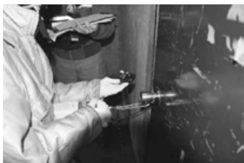
写真4 ドア開放力の測定状況
