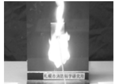
写真5 トラッキング放電
