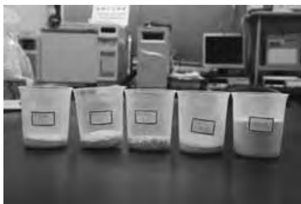
写真12 油吸着剤5種類各5gの体積比較 (向かって右がパーライト)
