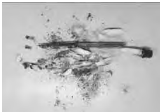
【写真7】 水槽用ヒーターの分解状況
