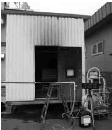
写真1 実験設備の概観 (燃焼実験ユニットと送水装置)
