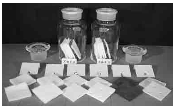
写真5 溶剤投入前の状況
