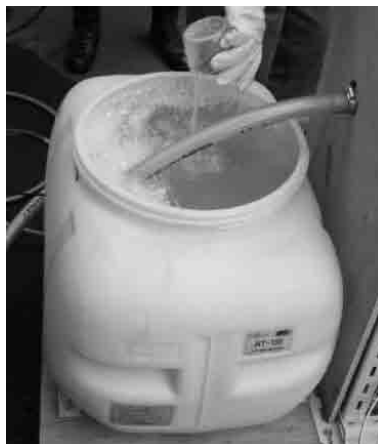
写真2 消火剤の混合攪拌状況
