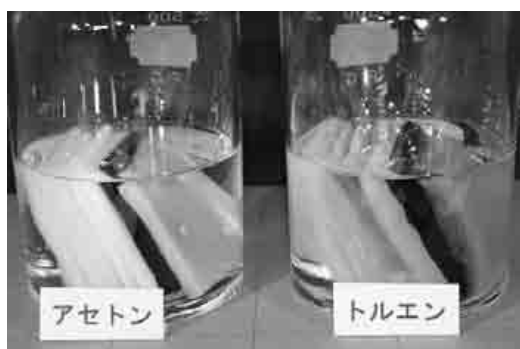
写真6 溶剤を投入した状況（広口瓶内、左から吸着材A、B、C、D、E、F）
