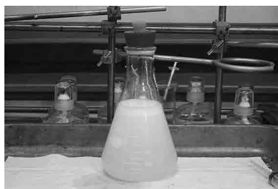
写真 3 炭酸ナトリウム投入時の状況
