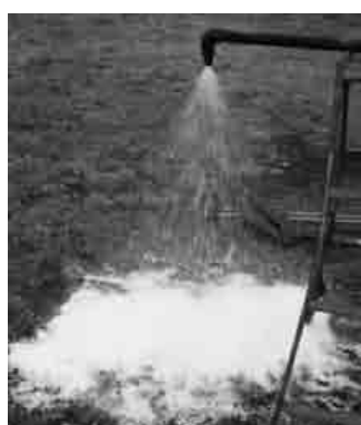
写真4 放射形状 (新型消火剤 0.3 %混合時)
