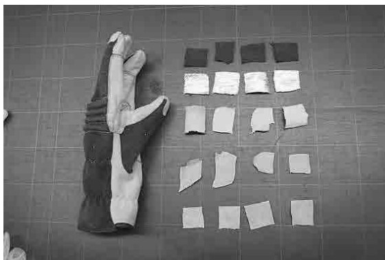
写真1 カットサンプルの状況
