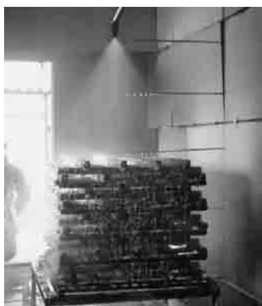
写真 5 鉛直方向の放射用ノズル
