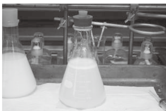
写真7 反応液にチオ硫酸ナトリウム添加状況
