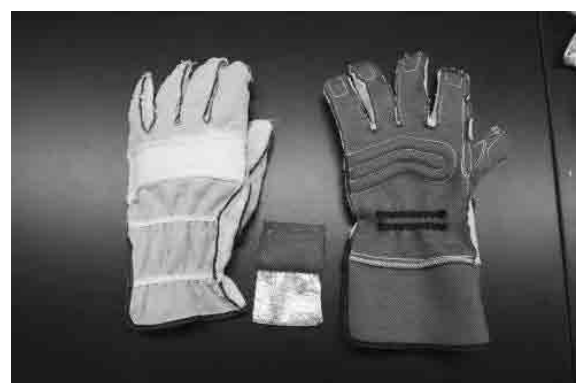
写真5 手袋を裏返した状況（甲側） 左) 補強済 右) 未補強 中) アルミフィルム蒸着加工生地
