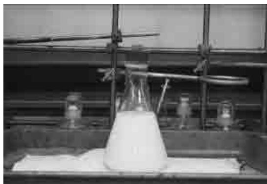
写真6 反応液に炭酸ナトリウムを添加
