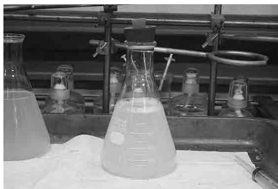
写真 4 チオ硫酸ナトリウム投入時の状況
