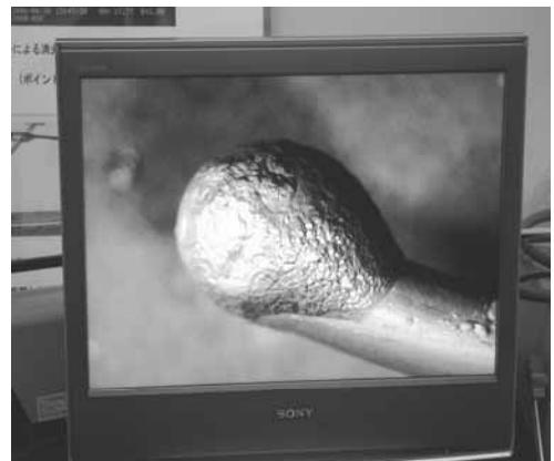
写真 11 写真 10 の銅線溶痕拡大
