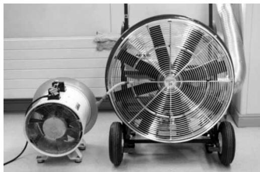
写真3 送排風機（左）と可搬式ブロアー（右）
