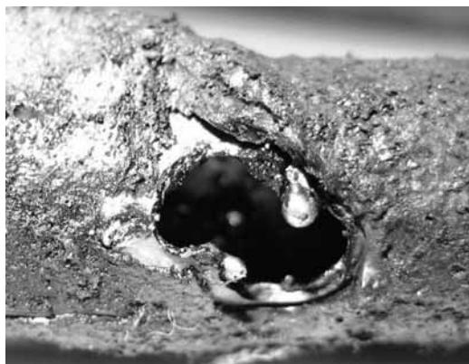
写真 12 火災現場の銅管穿孔状況
