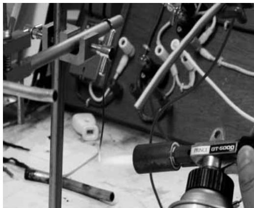
写真 10 ガスバーナーにて銅線加熱
