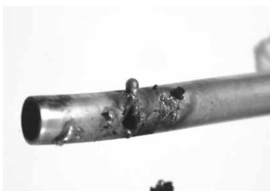
写真 6 銅管穿孔状況拡大
