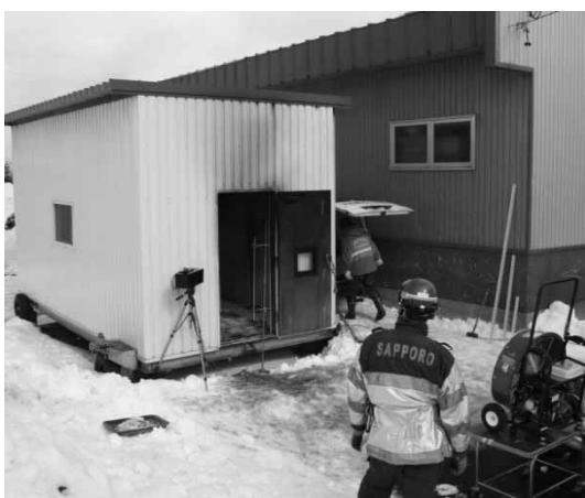
写真1 燃焼実験ユニットと可搬式プロアー
