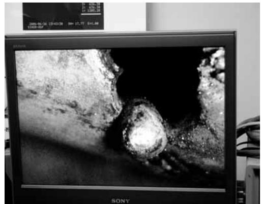
写真 13 写真 12 の銅管溶痕拡大
