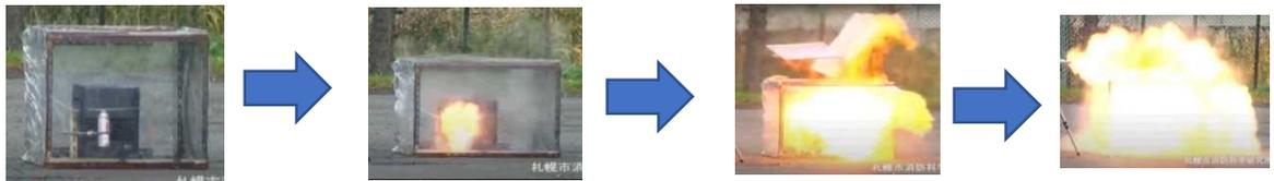
カセットガスボンベを加熱すると、ボンベが破裂し一気に爆発して危険です
