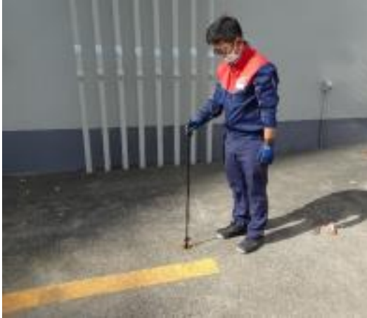
⑤漏えい検査管の底まで挿入する
