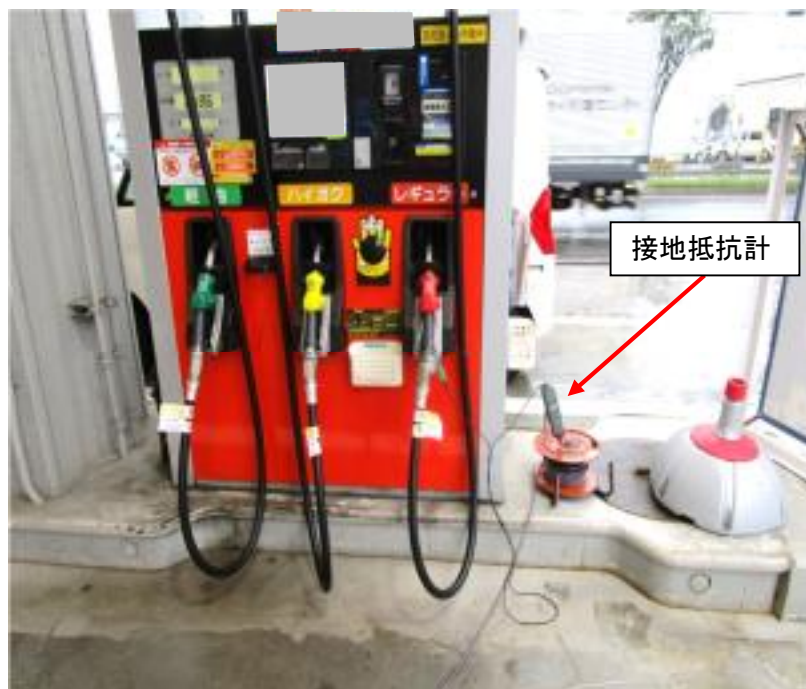
【接地抵抗の測定例（2極法）】
