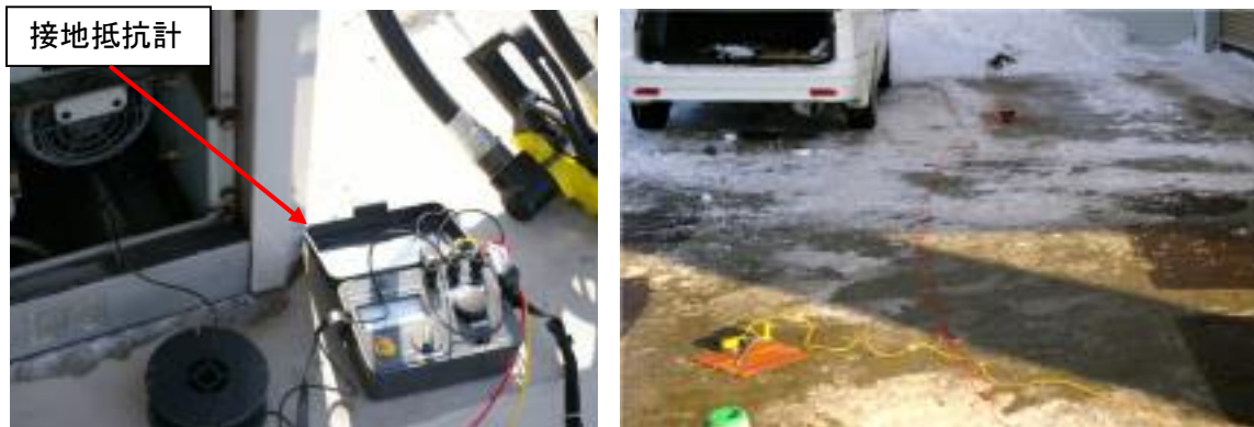
【接地抵抗測定の例（3極法）】※写真は計量機を測定しているところ
