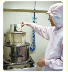
▲実際にパンを割いて粉砕機に投入！12mmの目のパン粉が出来上がります
