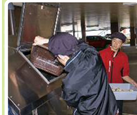
▲よく混ぜた生ごみを、業務用生ごみ処理機(発酵型食材製造装置)に入れていれるのみ。時間をかけて発酵・乾燥することで、体積は約4分の1になるそうです
