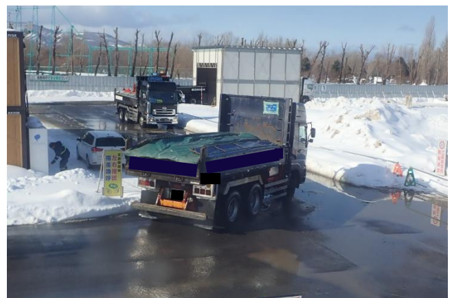
荷台のシート状況
