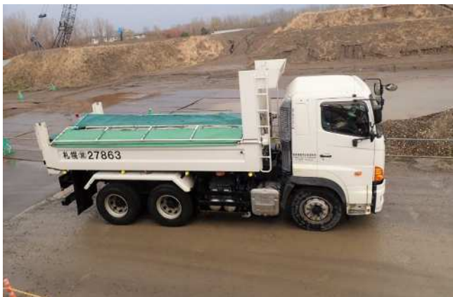
ダンプトラック荷台シート被覆状況
