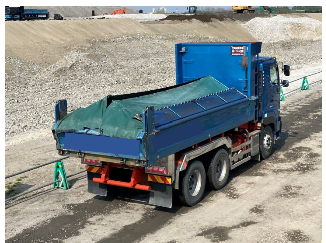
荷台のシート状況
