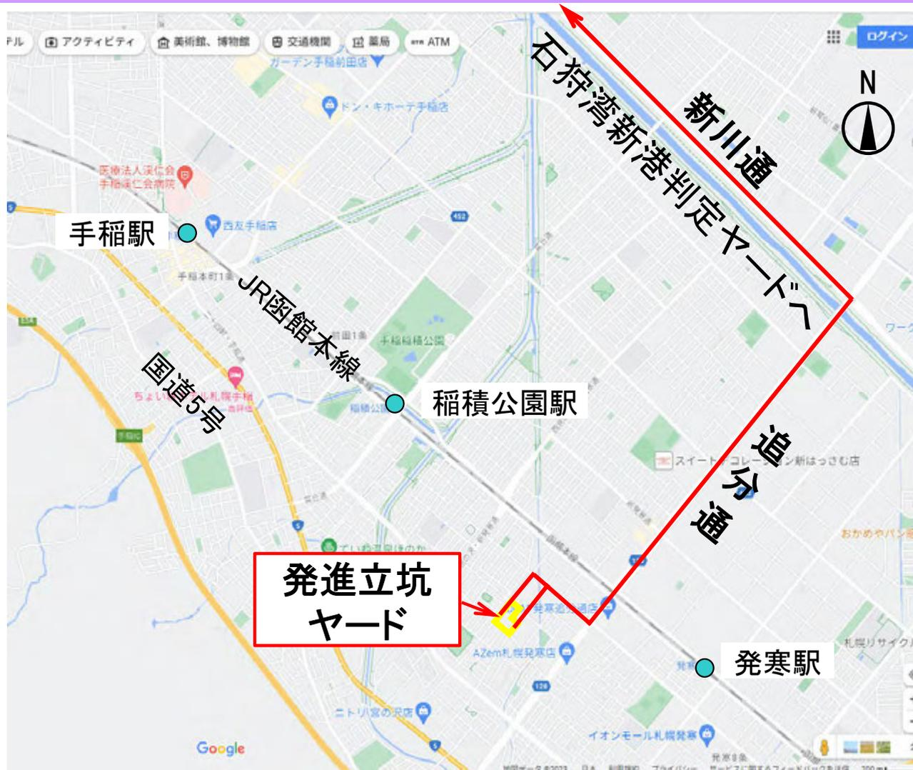
※ 判定ヤードとは、シールド工事の発生土を対策土か無対策土かを判定するための作業場で、判定後は受入地へ運搬します。
