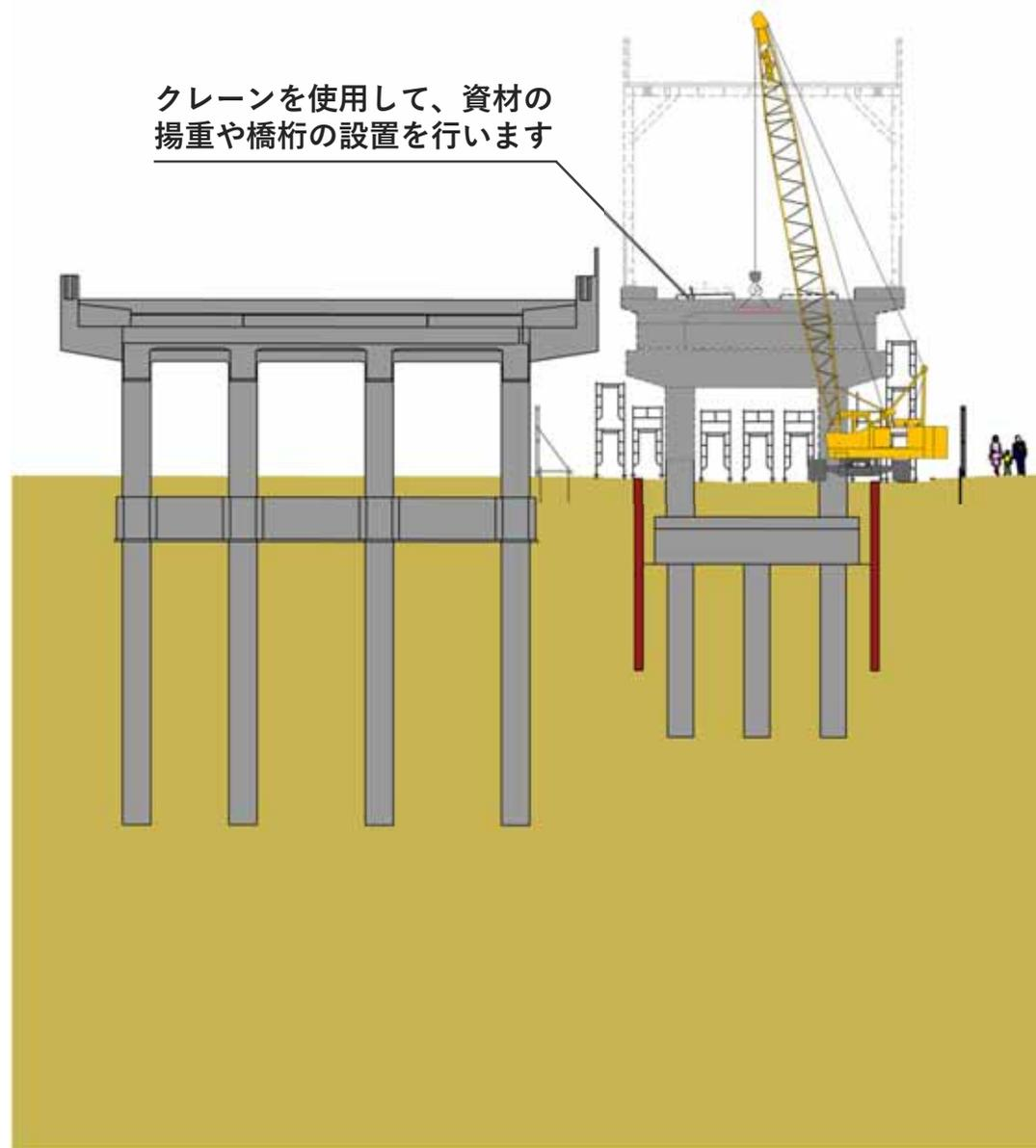
クレーンを使用して、資材の揚重や橋桁の設置を行います
