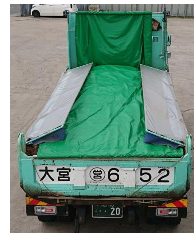
シート掛け養生
