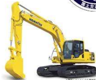
油圧ショベル 盛土を整形する
