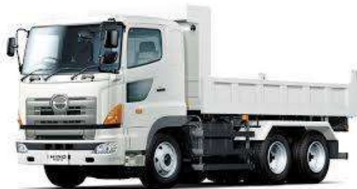
ダンプトラック 土を運搬する
