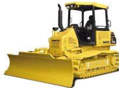
ブルドーザ 運ばれてきた土を敷き均す
