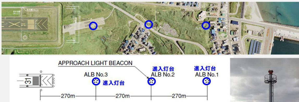
図 2(2)-18 奥尻空港の進入灯台の事例
