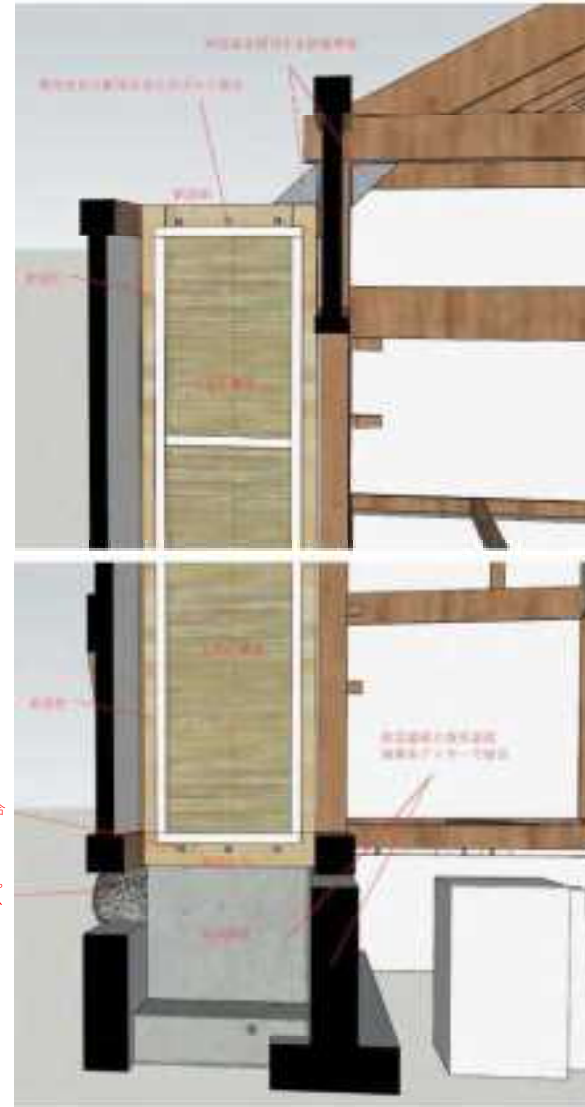
既存土台と新設土台のボルト接合
