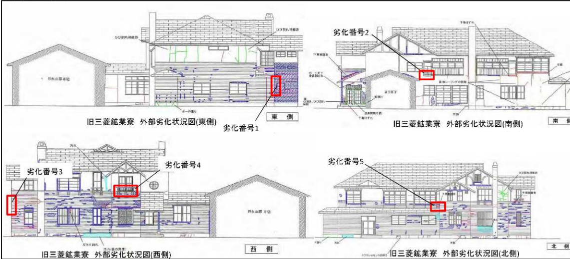
劣化番号1 下見板の腐食及び 窓枠のゆがみ、腐食
