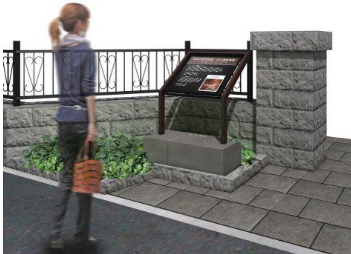
G4 名称サイン（全体寸法：W900×D500×H1200 盤面寸法：W600×H600）
