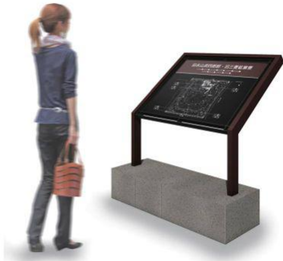
G4 名称サイン（全体寸法：W900×D500×H1200 盤面寸法：W600×H600）
