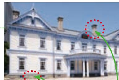
豊平館では土台の部分に丈夫な札幌硬石が、煙突には熱に強い軟石が使われたと考えられているよ
