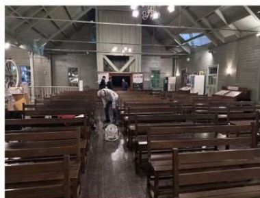
写真 換気回数測定の様子(二酸化炭素ポンプ等の設置状況)
