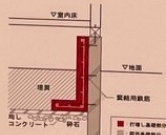
既存基礎に増設用基礎配筋の様子 鉄筋コンクリート敷設
