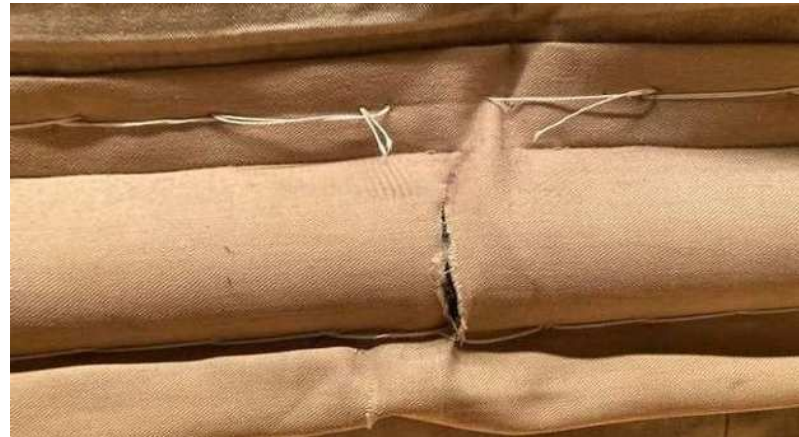
劣化部②(下部パイプ袋)
