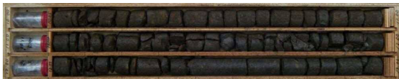
写真-4.1.4 Swt 層のコア写真（No.3地点：GL-10.00～13.00m間）
