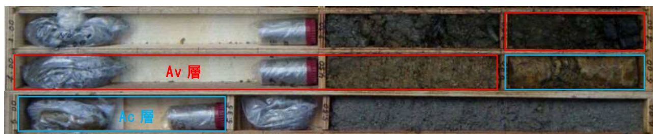
写真-4.1.2 Av・Ac 層のコア写真（No.1 地点：GL-3.00～6.00m 間）
