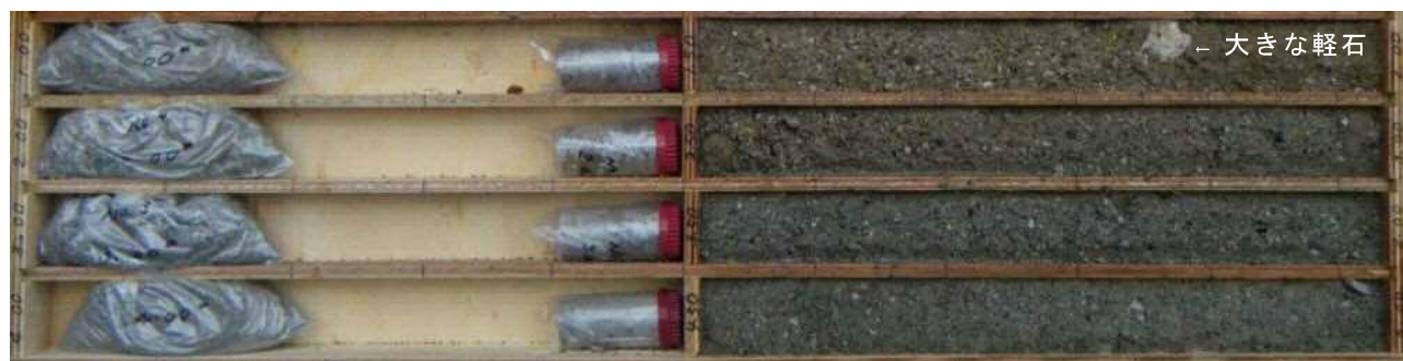
写真-4.1.3 Sv 層のコア写真（No.3地点：GL-1.00～5.00m間）
