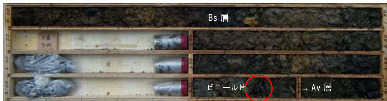
写真-4.1.1 Bs 層のコア写真（No.1 地点：GL-0.00～4.00m 間）
