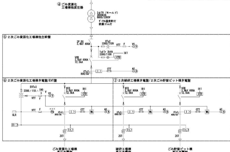
受変電設備 単線結線図
