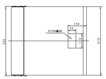
壁設置型・表示部無し壁設置型 車両受付機(参考図)
