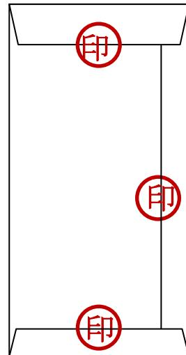
イ 郵便により提出する場合は二重封筒として、外封に「令和2年3月27日13時10分開札〔プラスチック選別センター残さ運搬業務〕の入札書在中」の旨を記載し、上記2宛に入札書の受領期限までに送付しなければならない。
