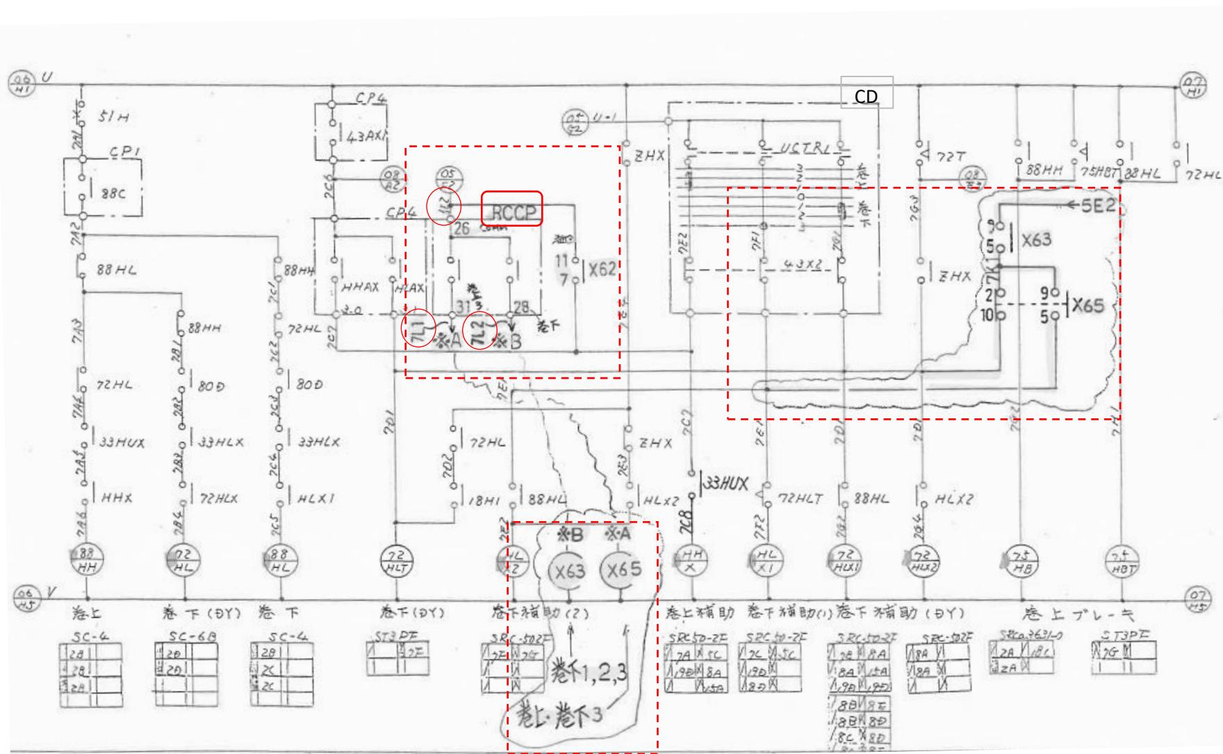
破碎工場操作盤からの運転操作廃止
