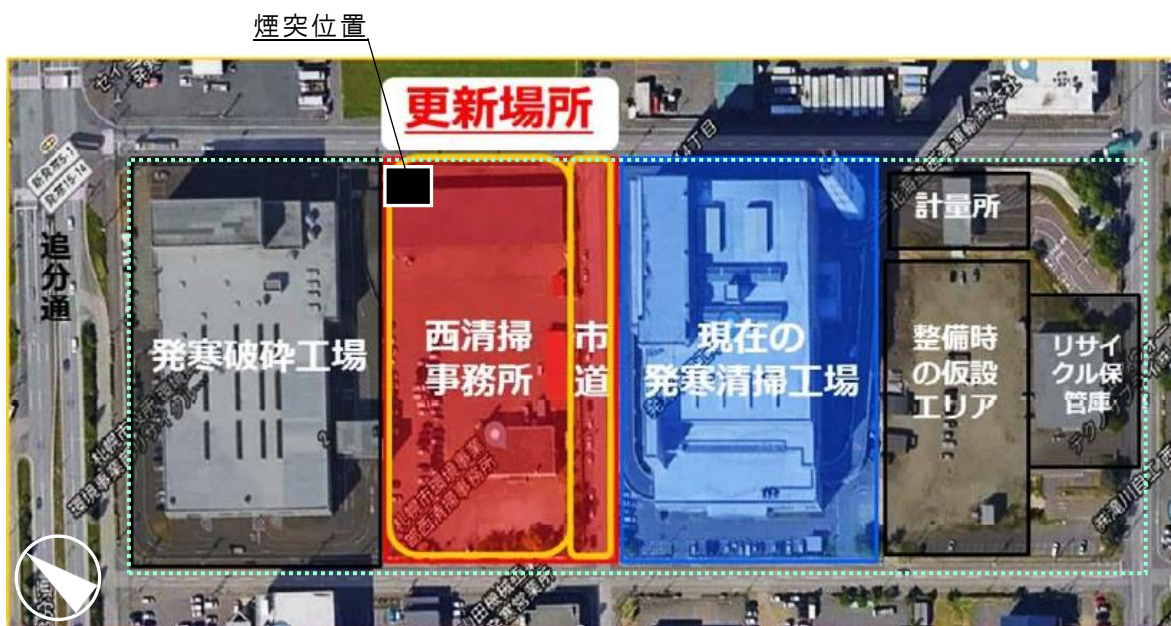
図 2-4-5 北側に煙突を配置する B 案の施設計画
