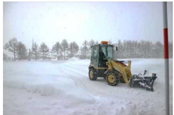
ホイールローダーによる除雪作業
