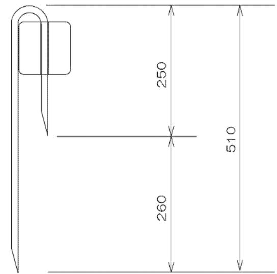
アンカーピン (SS400、呼び径D13、曲げR29内外)
