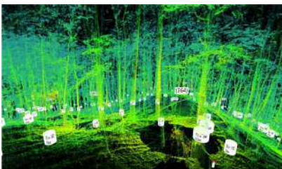
デジタル計測機器による立木調査
