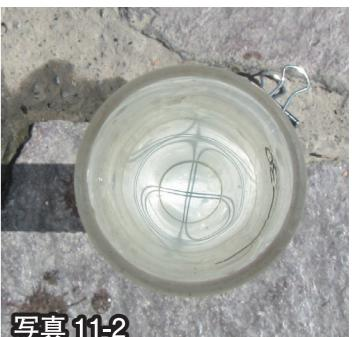
●水を入れ、上からのぞき込み底の二重線がはっきり見える高さを計測する。
