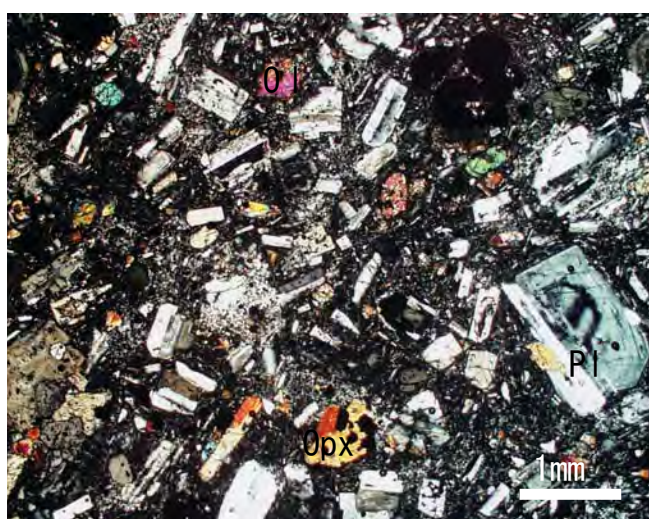
かんらん石-単斜輝石-斜方輝石安山岩 (藻岩山溶岩 11a, 060723-12, クロスニコル)
