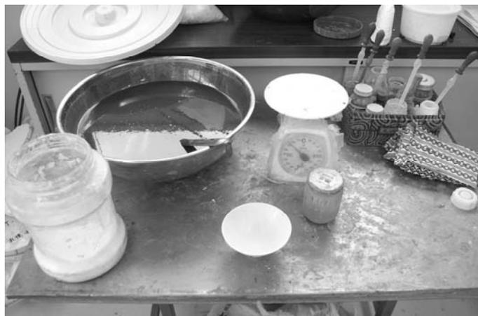
図VII-38 樹脂の調合台。左手前は増粘剤。左奥が着色済みの樹脂。中央は調合用の容器とスケール。スケールの針は容器を載せたときゼロになるよう調節してある。右奥は各種硬化剤用のピペット。
