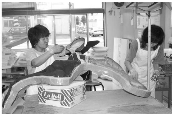
図VII-36 裏面のシリコンがけ
