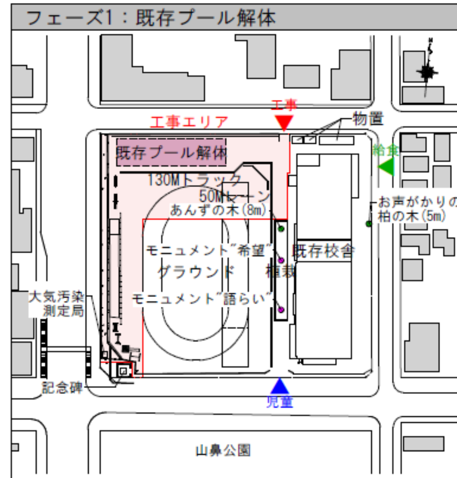
R8 R9 R10 R11 R12 フェーズ1 6ヶ月 フェーズ2 23ヶ月 フェーズ3 18ヶ月 フェーズ4 8ヶ月 既存プール解体 新設校舎 物置建設 既存校舎解体 グラウンド整備 グラウンド不使用期間 3年 9ヶ月
