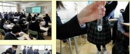
硝酸銀水溶液を加えることで塩化銀の沈殿が生成され、塩化物イオンが含まれていることが分かりました。
