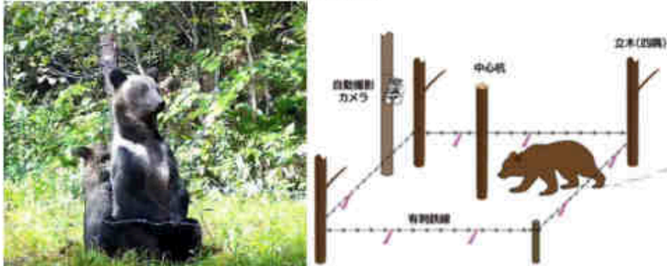
図 40 ヘア・トラップで背こすりするヒグマ(左)とヘア・トラップの構造(右)
