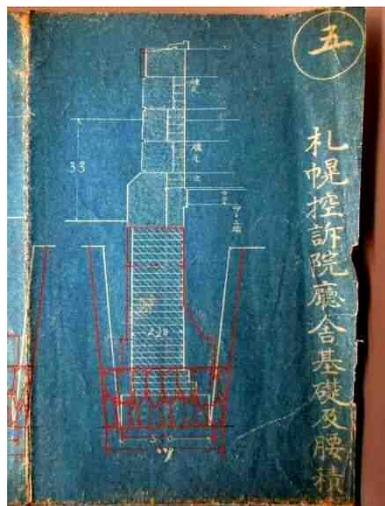
【図 4】基礎部分の外壁断面図面（地上部分でレンガと軟石が凹凸により噛み合わされていることがわかる）
