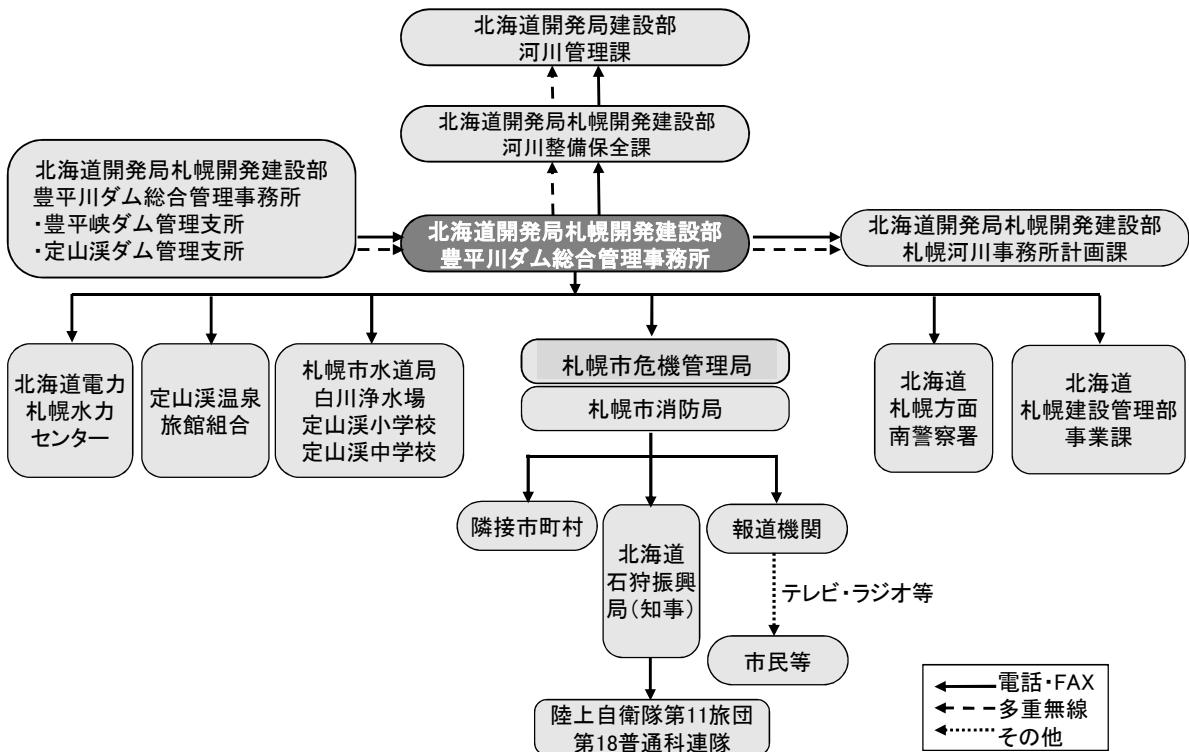
図 3-11 豊平峡ダム及び定山渓ダムの放流通報の連絡系統
