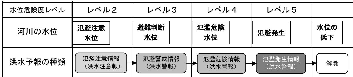
**図3-4 洪水予報河川の水位と洪水予報の種類**
