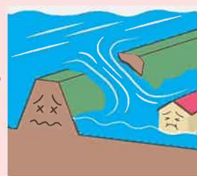
崩れた場所は一気に広がり、勢いよく水が流れ出し、家などに襲いかかります。
