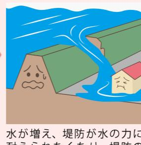
水が増え、堤防が水の力に耐えられなくなり、堤防の一部が崩れ始めます。
