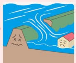
崩れた場所は一気に広がり、勢いよく水が流れ出し、家などに襲いかかります。
