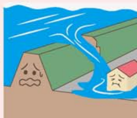
水が増え、堤防が水の力に耐えられなくなり、堤防の一部が崩れ始めます。
